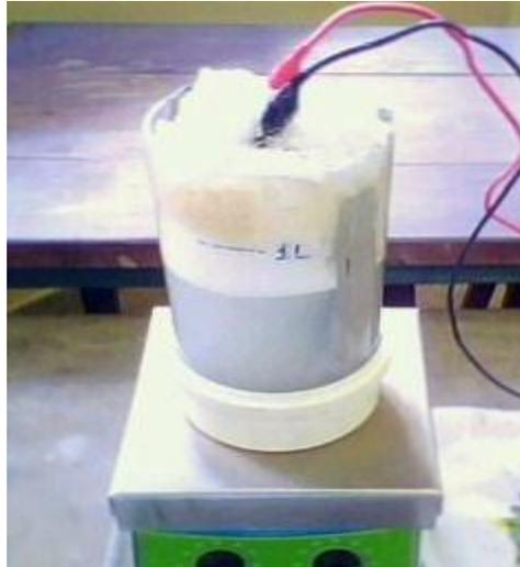
Figura 3 – Vista do reator com material flotado após tratamento. Fonte: Dados da pesquisa.
