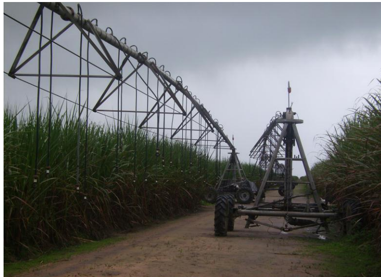
Figura 1. Pivô central rebocável, utilizado na irrigação com vinhaça. Fonte: Dados da Pesquisa.
